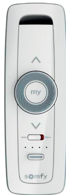
Dálkový ovladač pro předokenní žaluzie SOMFY pětikanálový, u Penthouse ovládání přes chytrou domácnost a tlačítka
